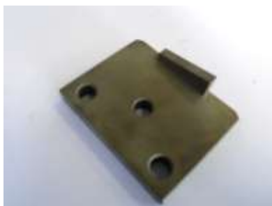
PUNZONE SCARICO ACQUA BINARIO:
